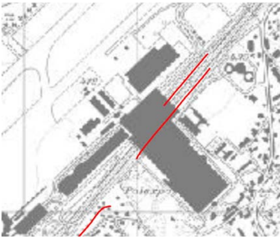
Bsp.: GE N01 Palexpo – Baulinien parallel zur Strassenachse, teilweise fehlend, keine vertikalen Begrenzungen.
