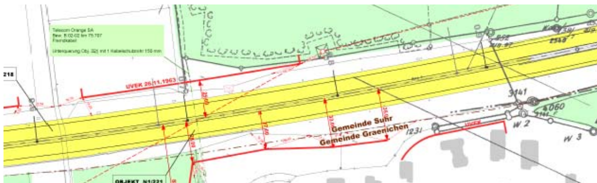
Bsp.: AG N01 Suhr - nicht geschlossene und fehlende Baulinien entlang von Wäldern
